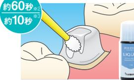
レジン部分の被着面にマルチプライマー リキッドなど、シランカップリング剤含有のプライマーを塗布し、乾燥※2させます。
