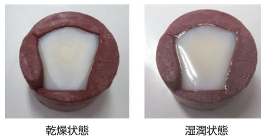
図2-2-1 接着試験用サンプル (左：乾燥状態 右：湿潤状態)
