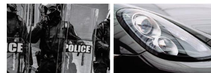
透明性を示す樹脂のなかで最高レベルの耐衝撃性を示す素材です。その特徴を活かして防護盾や自動車のヘッドライトカバー、スマートフォンなどの電子デバイスの筐体などに使われています。
